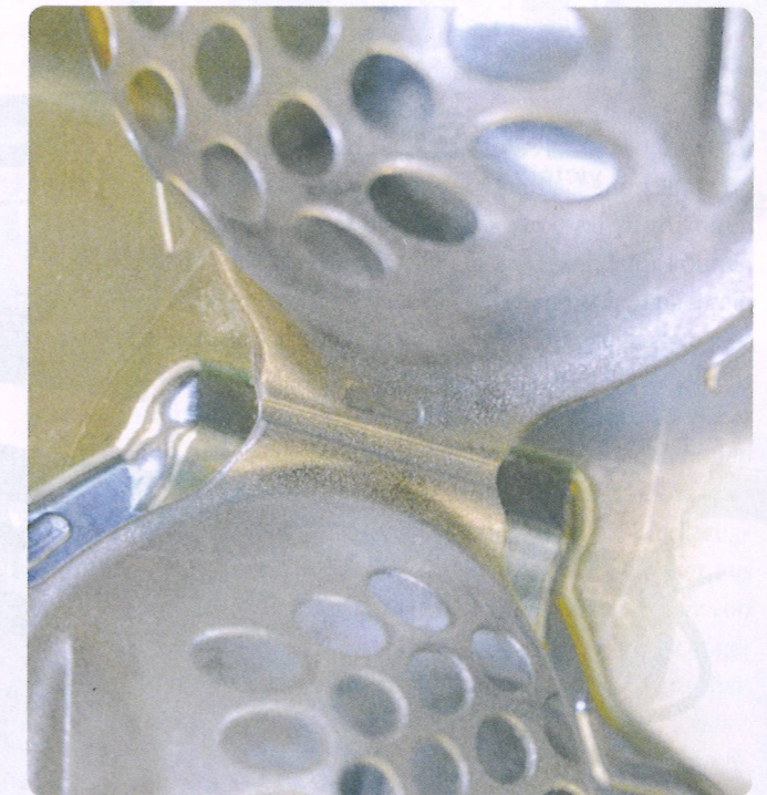
Detail des Schwertverschlusses im Angussystem. (Bild: FDU Hotrunner)
