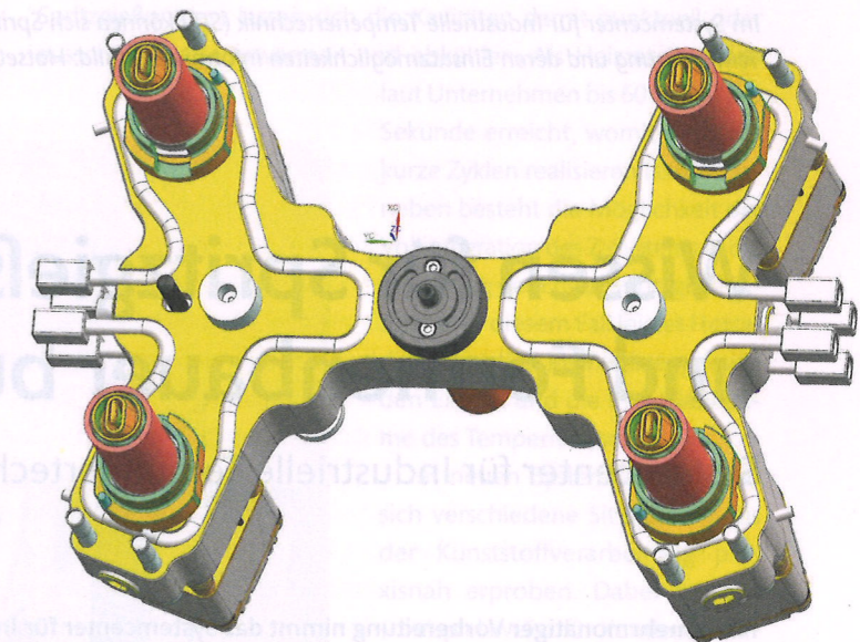
Heißkanalsystem in der CAD-Darstellung. (Bild: FDU Hotrunner)
