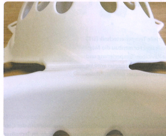
So sieht die Angusszone am Produkt aus. (Bild: FDU Hotrunner)
