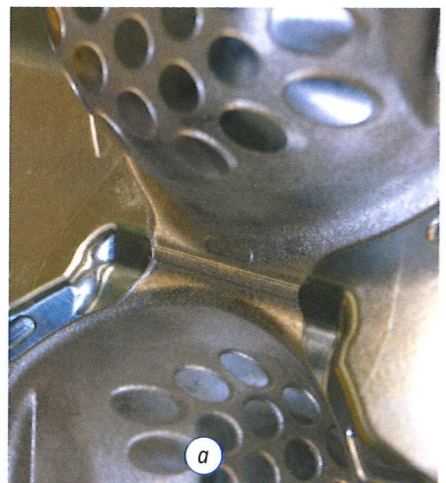
Рис. 2. Коллектор ГКС типа FDU SLS с X-образной конфигурацией
