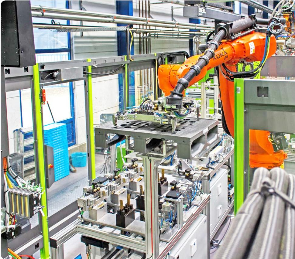
Kufen und Deck der Paletten werden synchron produziert. Ein Roboter zwischen den Maschinen montiert sie und legt sie ab. (Bild: Walther Faltsysteme)
